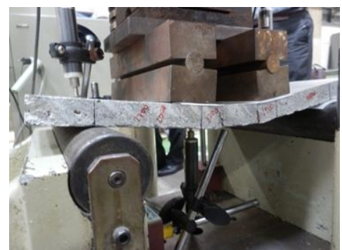
写真-3 曲げ試験の載荷状況 (終了時)
