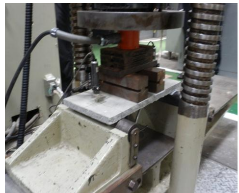
写真-2 曲げ試験の載荷状況 (開始時)
