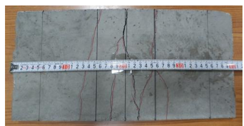
写真-4 曲げひび割れの分散状況
