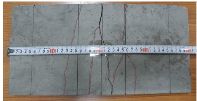
写真-3 曲げひび割れの分散状況
