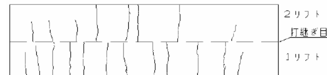
図-5 打設4週間後のひび割れ図
